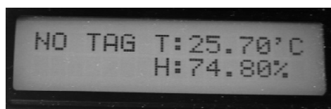
Fot. 2. Brak tagu RFID w zasięgu, zakomunikowane jako „NO TAG” oraz aktualna temperatura „T:” i wilgotność względna „H:”
