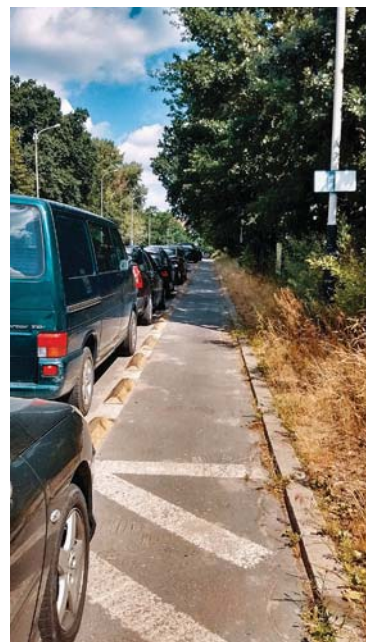
Fot. 3 i Fot. 4. Pasy rowerowe przy ul. Pankiewicza w Łodzi kończą się parkingiem z wyznaczonym na jezdni obejściem pieszym. Rozwiązanie tego miejsca jest dosyć niejasne – mimo braku odpowiedniego oznaczenia niektórzy rowerzyści mogą uważać je za kontynuację pasa rowerowego. Widok w kierunku ul. Wojska Polskiego
