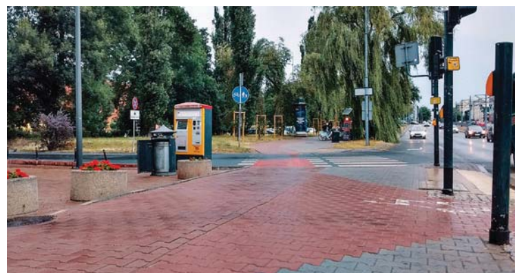
Fot. 6. „Śmieszka rowerowa” przy ul. Zachodniej. Fragment w pobliżu jednego z głównych wejść na teren centrum handlowego Manufaktura. Ścieżka rowerowa (czerwona kostka) kolizyjnie przecina chodnik
