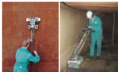
Rys. 7. Zastosowanie metody prądów wirowych w systemach badań nieniszczących firmy Test Maschinen Technik GmbH: a) wiroprądowa inspekcja rur o dużych średnicach w rurociągach przemysłowych oraz wytwórczych, b) kontrola skutków korozji konstrukcji blachowych, zbiorników i kotłów z użyciem manipulatora.
