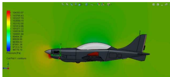
Rys. 3. Rozkład ciśnień opływu płatowca wzdłuż osi podłużnej
