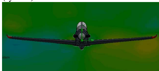
Rys. 17. Rozkład prędkości wzdłuż osi poprzecznej
