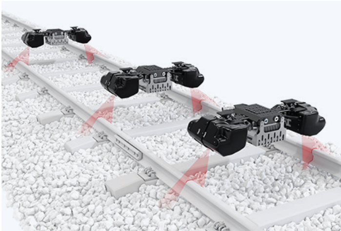
Rys. 6. Cięciwowy system pomiarowy nierówności toru
