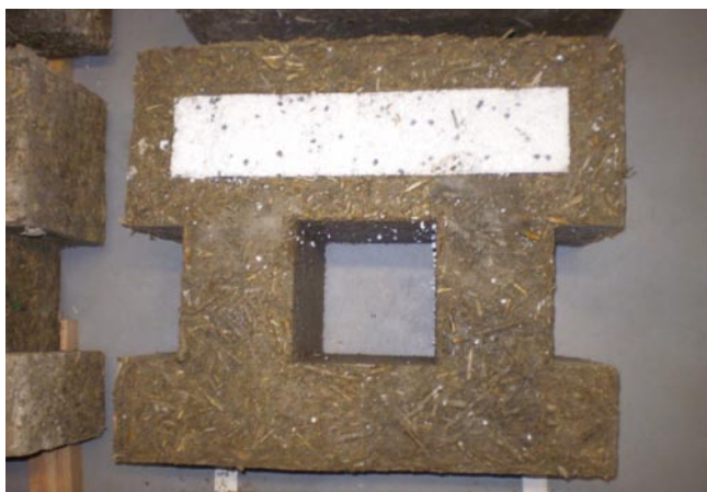
Rys. 2. Wyprodukowany ekologiczny pustak
