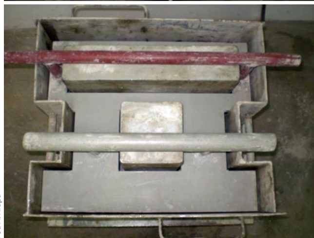
Rys. 1. Stanowisko do produkcji ekologicznych pustaków
