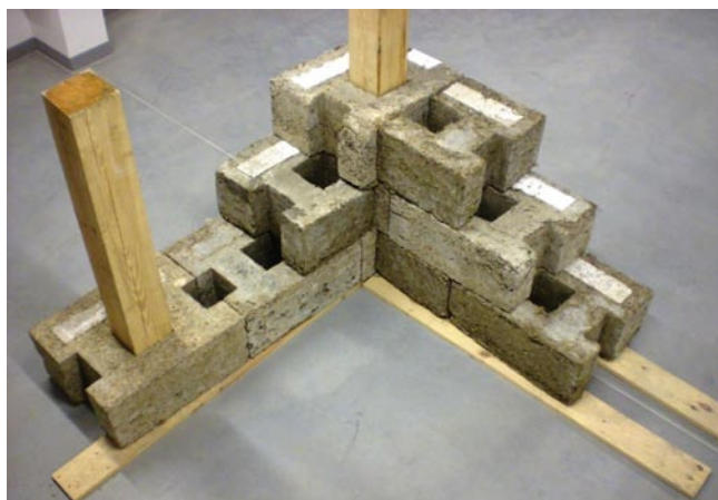
Rys. 3. Przykładowy narożnik ściany wykonany z wytworzonych pustaków z ekologicznym wypełniaczem organicznym
