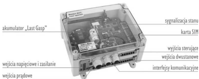
Rys. 6. Sterownik DALI-box z funkcjami pomiaru mocy i harmonicznych prądu
