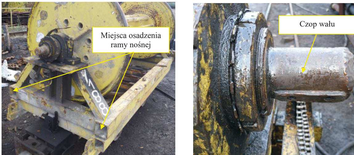
Rys. 4. Linowóz typu WKL.001 – widok ogólny oraz czop wału [1]
