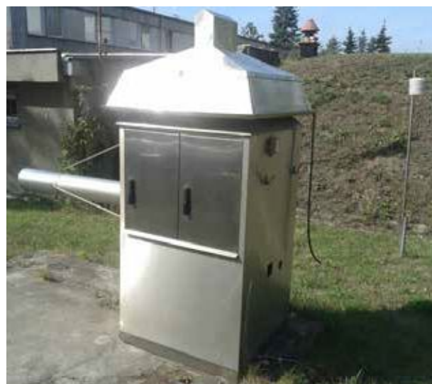
Fot. 1. Stacja ASS-500 projekt autorski Centralnego Laboratorium Ochrony Radiologicznej
