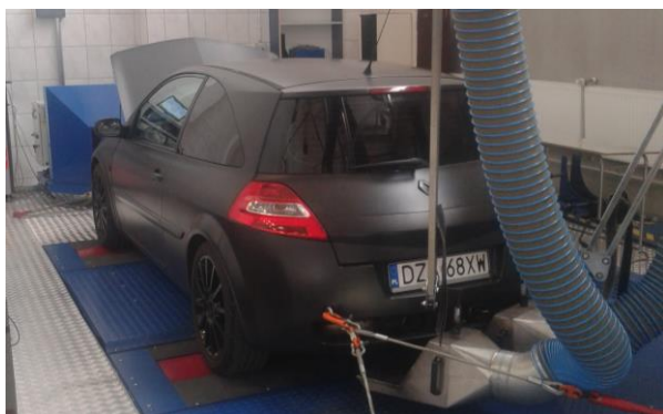
Rys. 2. Stanowisko do badań eksperymentalnych.
