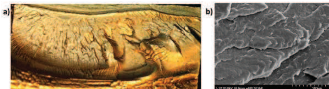
Rys. 3. Widok przełomu próbki pobranej z górnej części zbiornika R0-G: a) powiększenie 1x, b) zdjęcie SEM o powiększeniu 400x.
