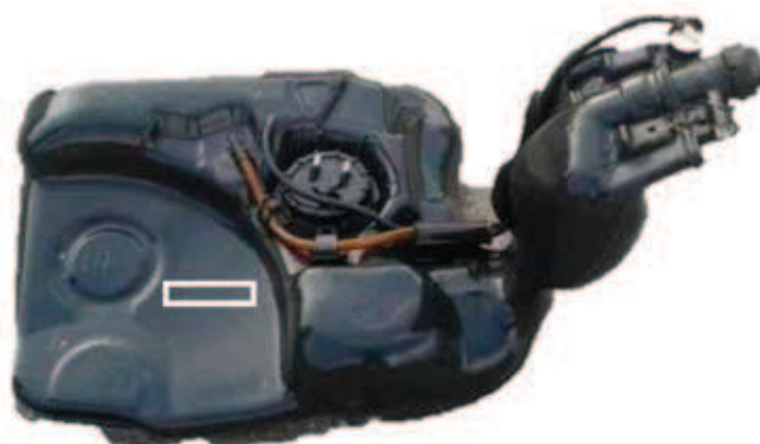
Rys. 2. Widok zbiornika z zaznaczonym miejscem i kierunkiem wycinania próbki.
