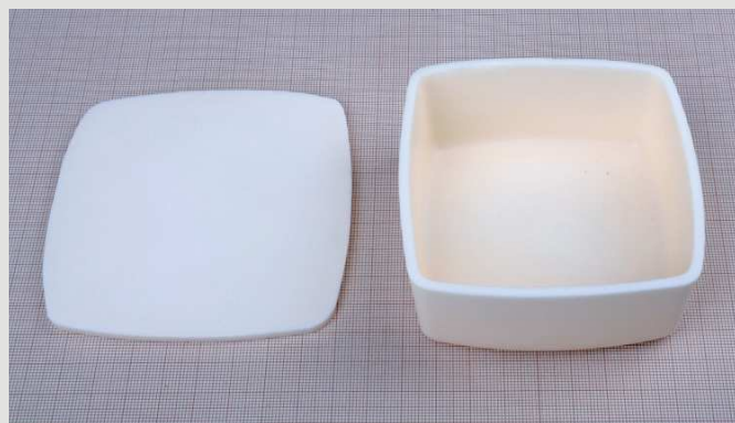
Fot. 4. Tygiel alundowy (z proszku Nabalox) o maksymalnej temperaturze pracy 1500°C z wieczkiem z tego samego materiału
