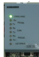
Rys. 8. Rejestrator zdarzeń typu EZE-2 [opracowanie własne]
