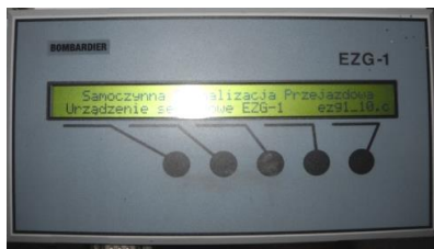
Rys. 7. Widok panelu diagnostycznego typu EZG-17 [opracowanie własne]
