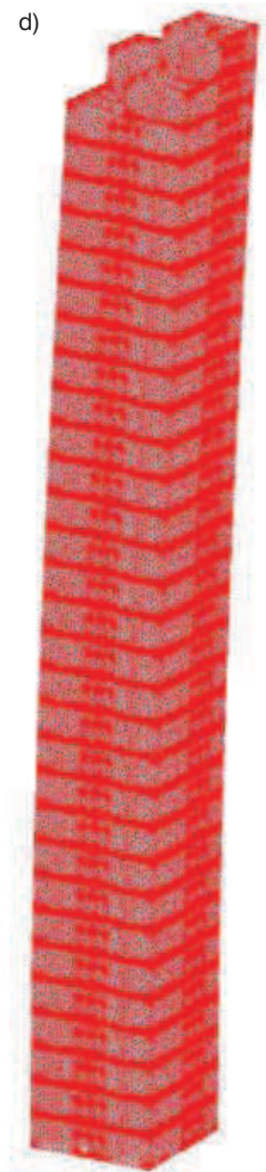
Rys. 24. Mapy rozkładu sił w trzonie – poziom 15: a) siły normalne, b) momenty względem osi pionowej, c) momenty względem osi poziomej, d) deformacja trzonu
