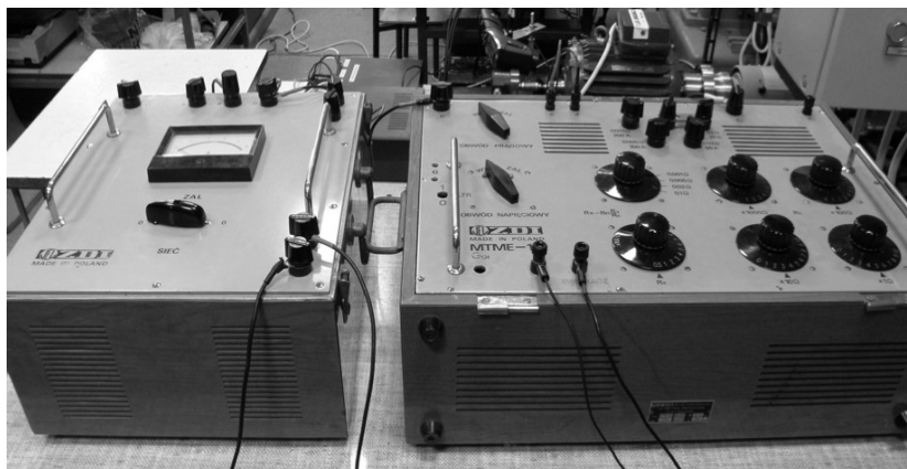
Rys. 7. Mostek MTME do pomiaru rezystancji uzwojenia pod obciążeniem
