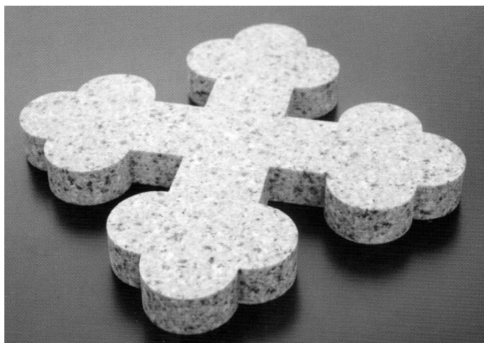
Rys. 3. Element z surowca mineralnego wykonany metodą AWJM
