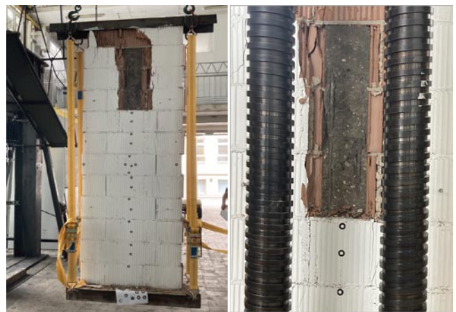
Rys. 8. Widok zniszczonej ściany murowanej po badaniu wytrzymałościowym
