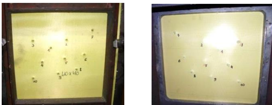
Fot. 10. Próbką kompozytu po badaniach odłamkoodporności od lewej: przód, tył próbki podczas badań odłamkoodporności
