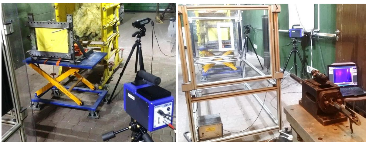
Fot. 1. Stanowisko do rejestracji zmian pola temperatury na powierzchniach (przedniej i tylnej) próbki kompozytu podczas badań kuloodporności
