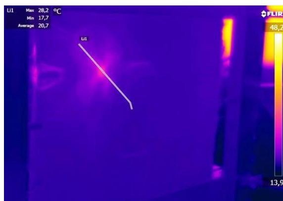
Fot. 5. Termogramy powierzchni tylnej kompozytu podczas strzału (nb. 9x19 mm z poc. FMJ o masie 8,0 g z prędkością 552 m/s) w czasie: 0 s i 5 s
