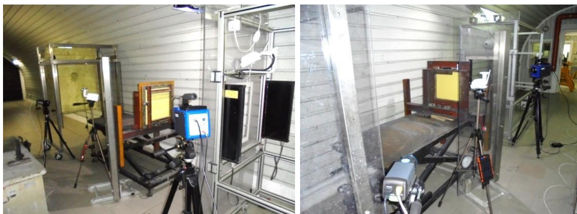
Fot. 9. Stanowisko do rejestracji zmian pola temperatury na powierzchniach (przedniej i tylnej) próbki kompozytu podczas badań odłamkoodporności
