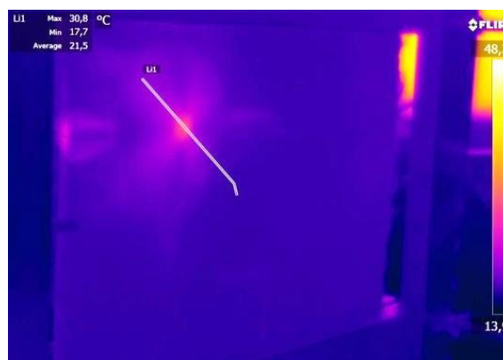
Fot. 5. Termogramy powierzchni tylnej kompozytu podczas strzału (nb. 9x19 mm z poc. FMJ o masie 8,0 g z prędkością 552 m/s) w czasie: 0 s i 5 s
