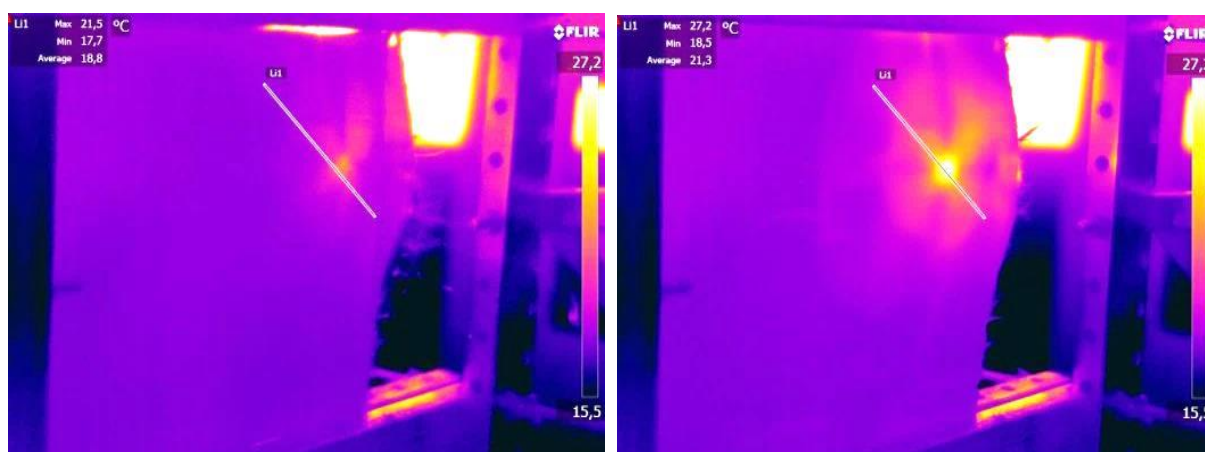
Fot. 7. Termogramy powierzchni tylnej kompozytu podczas strzału (nb. 357 Magnum z poc. FJCBSC) w czasie: 0 s i 5 s
