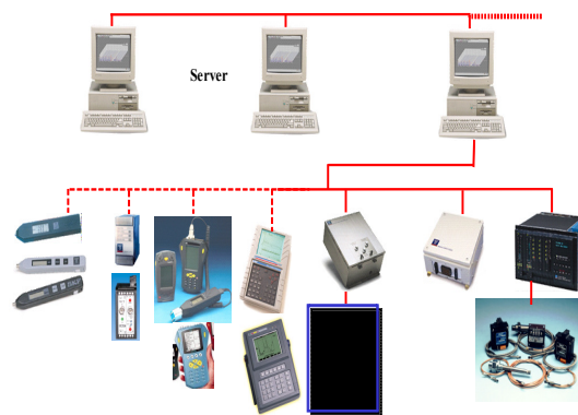
Rys. 9. Uproszczony schemat ideowy zintegrowanego systemu diagnostyki w danym zakładzie przemysłowym wg SKF [4, 5]
