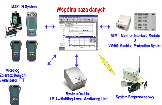
Rys. 10. Uproszczony schemat ideowy zintegrowanego systemu diagnostyki w danym zakładzie przemysłowym rozbudowany o bezprzewodowy przekaz sygnałów wg SKF [4]
