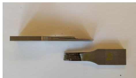
Rys. 2. Przykład zniszczenia próbki wzdłuż pasm wtrąceń niemetalicznych, statyczna próba rozciągania
