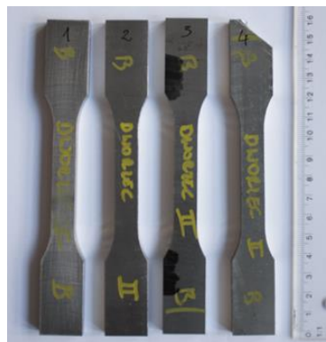
Rys. 6. Próbkę do rozciągania przed próbą statycznego rozciągania
