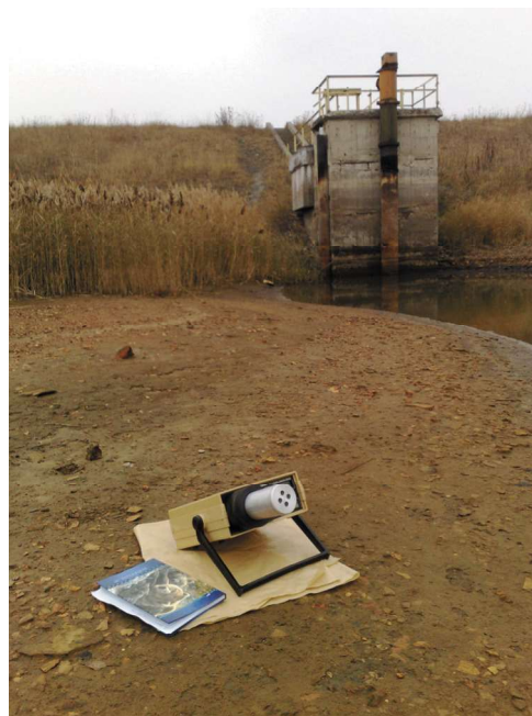
Rys. 1. Ilustracja konfiguracji geometrycznej pomiarów terenowych stężenia radonu ^{222}\text{Rn} przy zastosowaniu przyrządu PYLON AB-5
