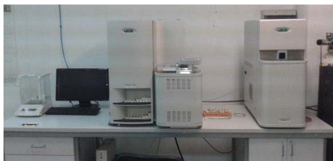
Rys. 4. Moduł CHN wraz z piecem do oznaczania udziału siarki
