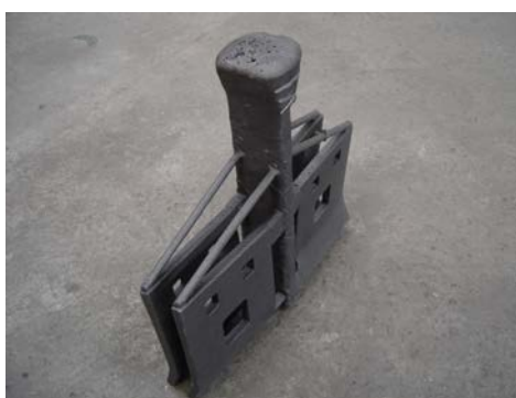
Rys. 3. Zestaw odlanych lemiesz Fig. 3. A set of cast blades
