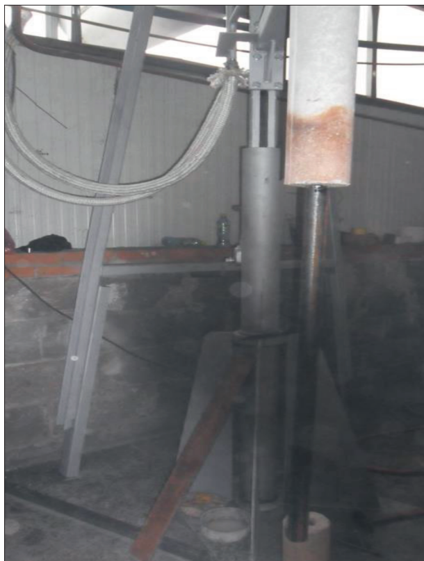
Rys. 11. Widok lancy po modyfikacji (dopasowaniu rur o większych średnicach)
