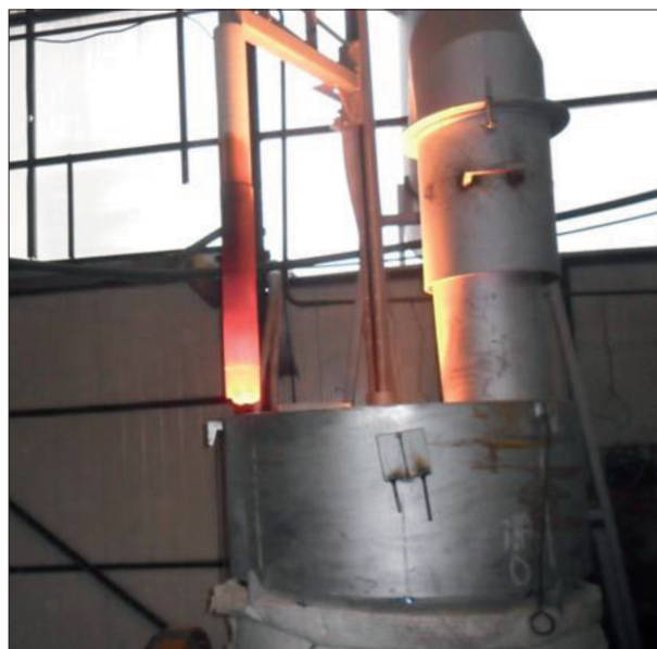
Rys. 10. Widok lancy po procesie dmuchania Fig. 10. Lance after blowing
