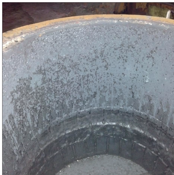
Rys. 12. Widok wyłożenia ogniotrwałego kadzi po 3 próbach
