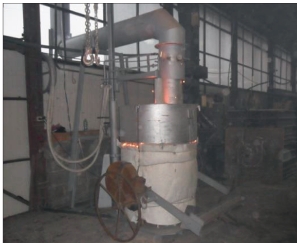
Rys. 7. Widok stanowiska doświadczalnego do wdmuchiwania lancą mieszanki tlen - argon
