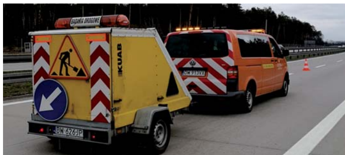
Fot. 5. Badania nośności nawierzchni ugięciomierzem FWD – zestaw KUAB 120 SPG [7]
