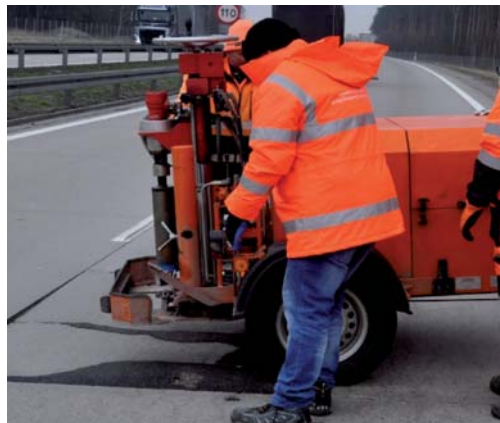
Fot. 6. Wykonywanie odwiertów w nawierzchni, autostrada A4, km 53+550 [7]
