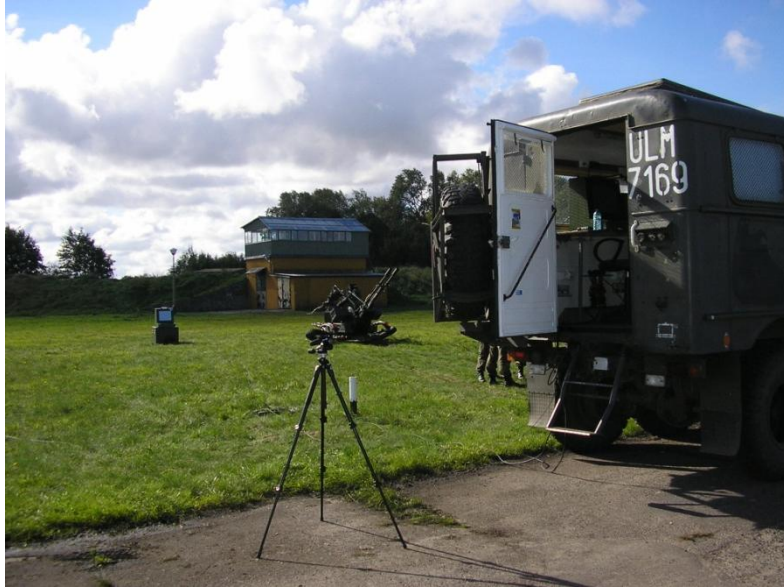
Fot. 1. Wóz dowodzenia AS-2 z aparaturą AWPKO i zestaw ZU-23-2KG na stanowisku badań Photo 1. Command and control vehicle AS-2 together with the apparatus AWPKO and the ZU-23-2KG set at the test range
