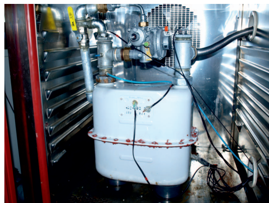
Fot. 5. Badany gazomierz umieszczony w komorze klimatycznej
