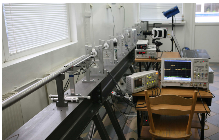
Rys. 2. Pręt Hopkinsona znajdujący się w laboratorium ITS Fig. 2. Hopkinson bar in the ITS laboratory
