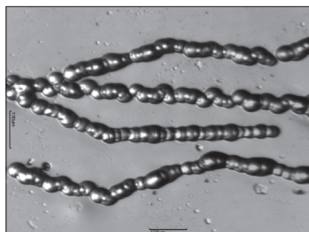
Rys. 1. Struktura mikrokanalów – kanały niejednorodne o nieznacznej głębokości. (Materiał: PDMS o grubości 100 μm; parametry pracy stacji grawerującej – moc: 0,2%, prędkość: 1,3%)
