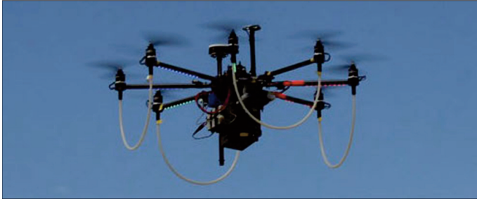
Rys. 6. Bezzałogowa platforma wielowirnikowa z zamontowaną specjalną anteną do precyzyjnego pozycjonowania [20]
