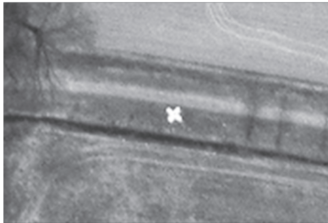
Rys. 4. Zdjęcie krzyża sygnalizującego punkt osnowy polowej, obraz pozyskany z wysokości 800 metrów (kanał czerwony). [opracowanie własne]
