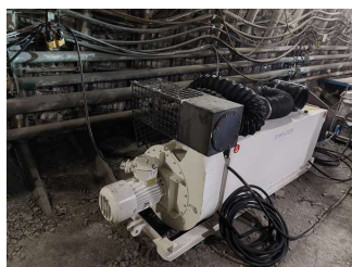
Rys. 5. Odpylacz suchy podczas badań w LW „Bogdanka”
