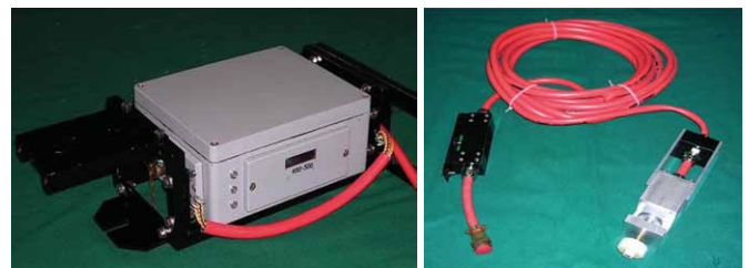
Fot. 2. Jednostka główna (z lewej) oraz jednostka zewnętrzna (z prawej) specjalnej aparatury do pomiaru metodą dynamiczną [11] naprężeń zmiennych doznawanych przez cięgła nośne składowiska podczas jego jazdy w szybie
