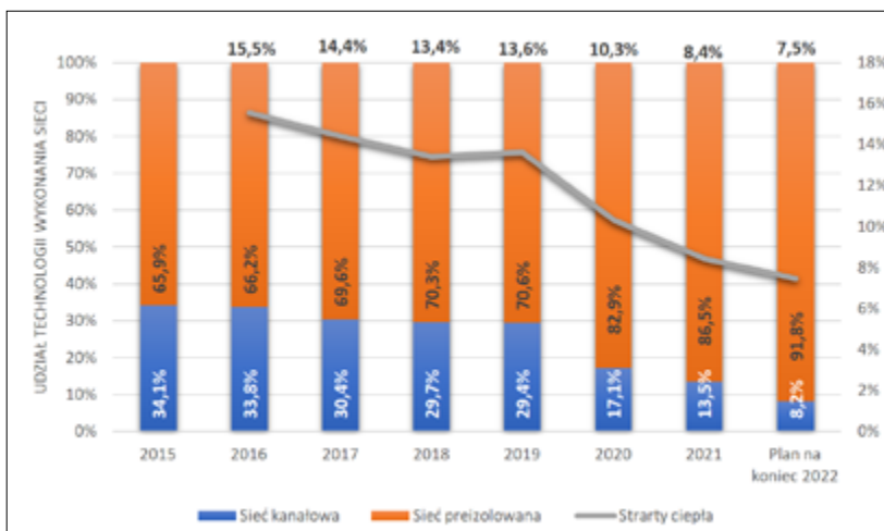
Rys. 2. Udział procentowy sieci kanałowych i preizolowanych, a straty na przesyle ciepła w latach 2015-2022
