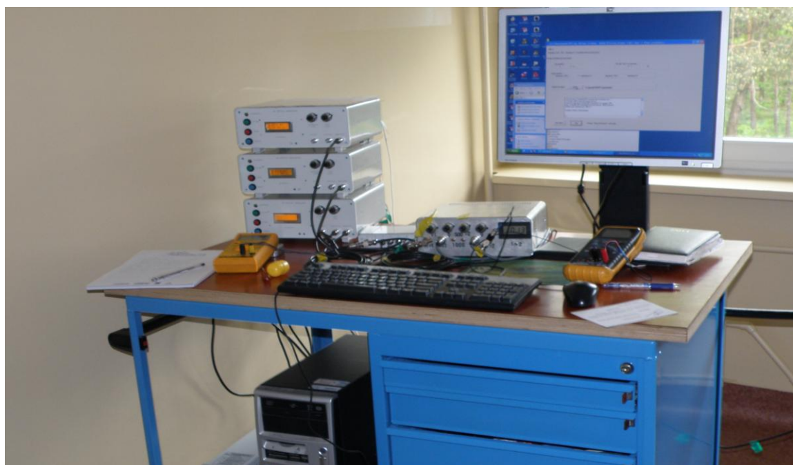
Fot.1. Trzykanałowa aparatura do pomiaru emisji akustycznej
