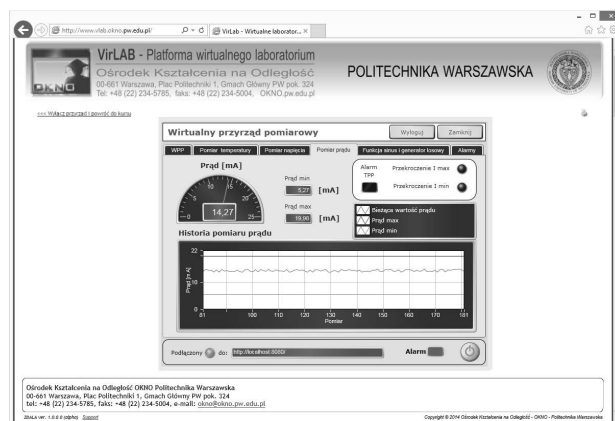
Rys. 7. Wirtualny przyrząd pomiarowy urządzenia podlegającego monitorowaniu z wykorzystaniem kamery USB
