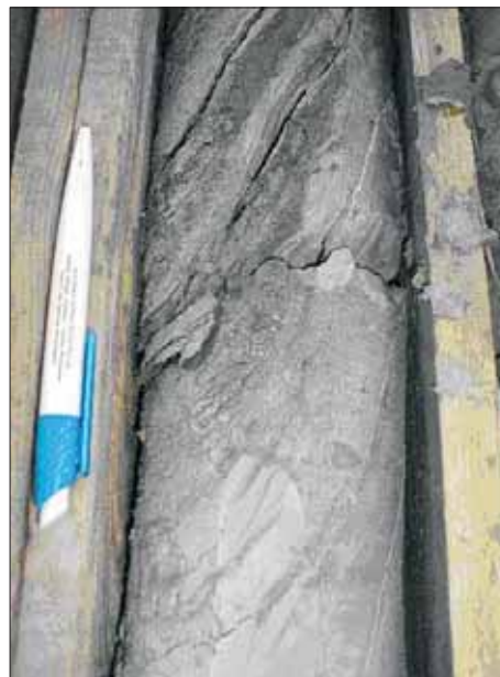
Fig. 10. Silnie zaburzone osady miocenijskie w rdzeniu z badawczego otworu wiertniczego w Wysokiej Wsi
