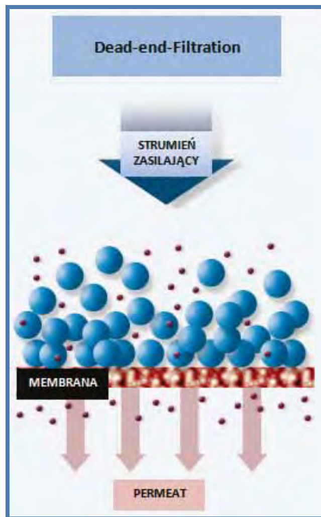
Rys. 1. Metoda dynamiczna – nanoszeniowa filtracji piwa. Fig. 1. Dynamic method – deposition of beer filtration.
