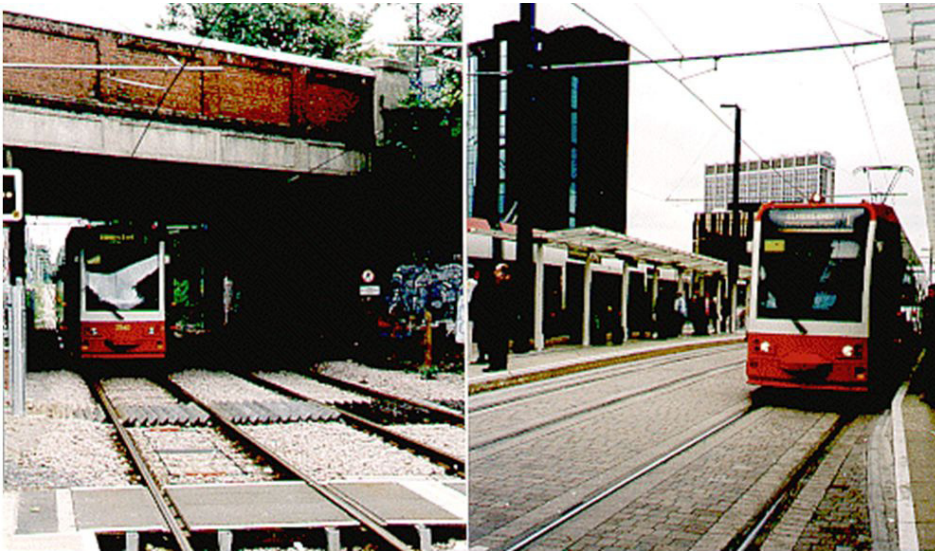
Rys. 3. System Tramlink w Londynie – tramwaj poruszający się po torach starego układu kolejowego oraz po miejskim torowisku (fot. K. Toupik)
