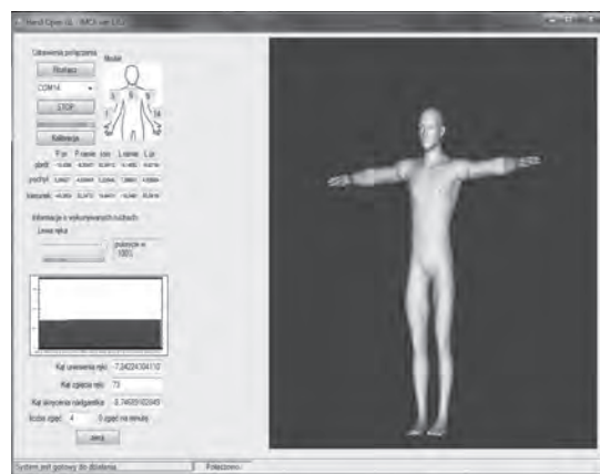
Rys. 1 Ekran programu do odtwarzania ruchów sylwetki człowieka na podstawie danych pobranych z zainstalowanych w wybranych miejscach ciała inteligentnych czujników ruchu
