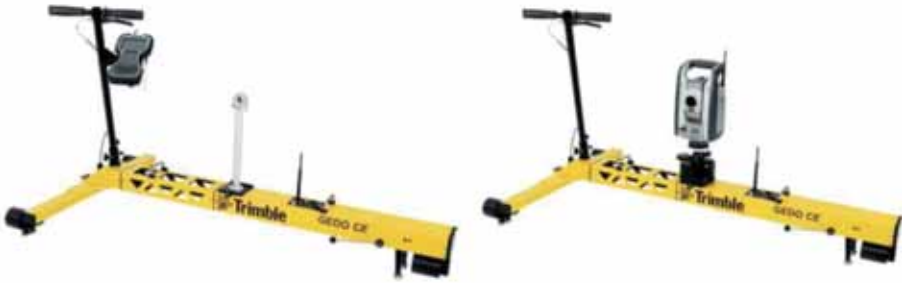
Fot. 5. Wózki pomiarowe systemu TRIMBLE GEDO CE 2.0
