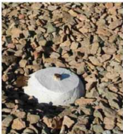
Fot. 1. Osnowa stabilizowana punktami ziemnymi
