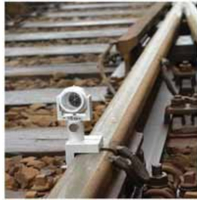
Fot. 4. Adapter z zamontowanym reflektorem pryzmatycznym
