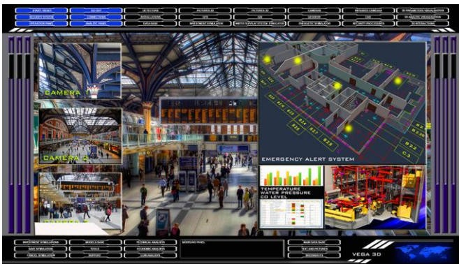
Obraz 5. Przykład menu operacyjnego PLATFORMY INFORMATYCZNEJ zarządzającej dużym dworcem kolejowym, wraz z panelem symulacyjnym sytuacji kryzysowych, opartym o punkty aktywne (żółte punkty na kadrze w górnym prawym rogu).
