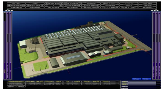
Obraz 7. Przykład zaawansowanego modelu VR3D dużego obiektu technicznego (hala serwisowa taboru szynowego z obiektami towarzyszącymi). Model wykonany w oparciu o skaning laserowy i aerofotogrametrię.
