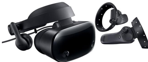
Obraz 3. Przykład zestawu gogli wirtualnych i dwóch manipulatorów VR 3D zakładanych na dłoń, służących do sterowania obrazem wirtualnym i do uruchamiania funkcji operacyjnych PLATFORMY INFORMATYCZNEJ.
