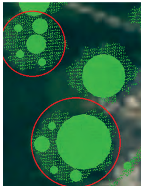
Ryc. 5. Przykład błędnego wygenerowania danych wektorowych dla drzew wskutek nieprawidłowego doboru parametru promienia korony
