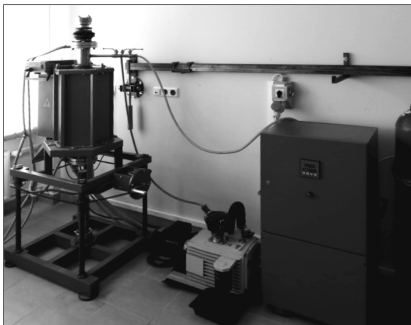
Fig. 1. Czyłok PRC 77/1150 Vacuum furnace
