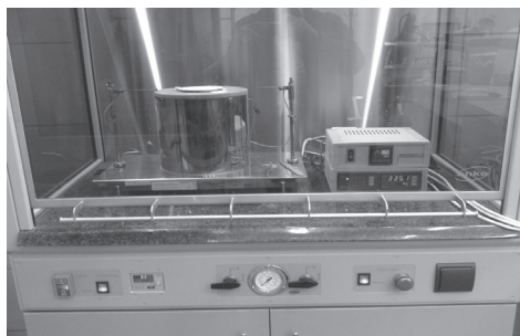
Rys. 4, 5. Prawidłowe wykorzystanie wentylacji prac badawczych przy określaniu temperatur zapłonu pyłów
