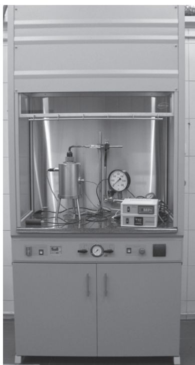
Rys. 4, 5. Prawidłowe wykorzystanie wentylacji prac badawczych przy określaniu temperatur zapłonu pyłów
