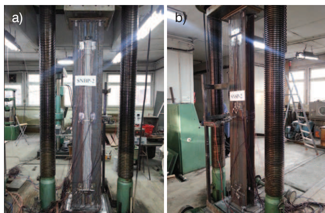
Rys. 2. Stanowisko badawcze słupów serii: a) SNBP i b) SNSP
