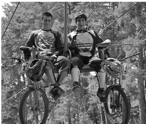
Fot. 8. Przewóz zawieszonoego roweru poprzez zahaczenie przodem siodełka o płaszczyznę poziomą siedziska krzeselka [6]
