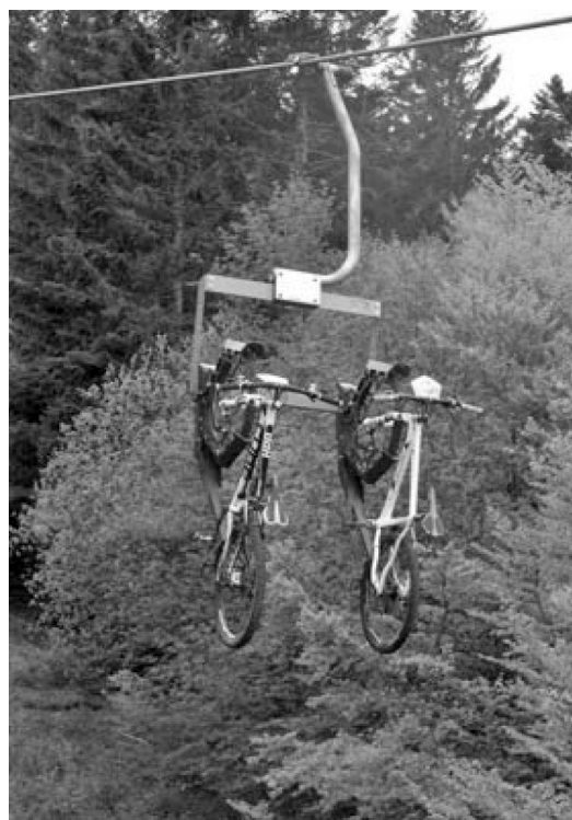
Fot. 11. Uchwyt rowerowy firmy Alpi Mountain. Rower podwieszony za przednie koło do specjalnego pojazdu transportowego kolei linowej [7]
