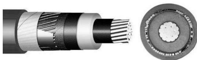
Rys. 1. YHAKXS 1x120/50 mm 2 – kabel (K) elektroenergetyczny z żyłą aluminiową (A) o przekroju 120mm 2 , żyłą powrotną miedzianą o przekroju 50 mm 2 o polu promieniowym (H), o izolacji z polietylenu usieciowanego (XS) i o powłoce z polwinitu (Y); U_n=12/20 kV [4]
