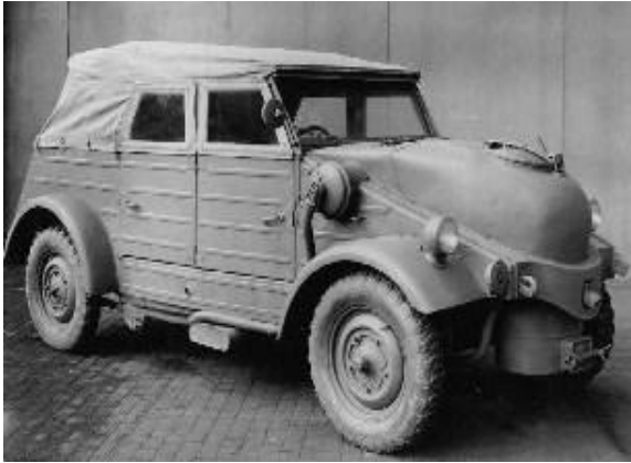
Ryc. 14. Kubelwagen na gaz drzewny
