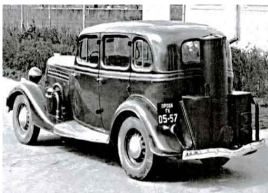
Rys. 9. Gaz M1 G widok tylny instalacji
