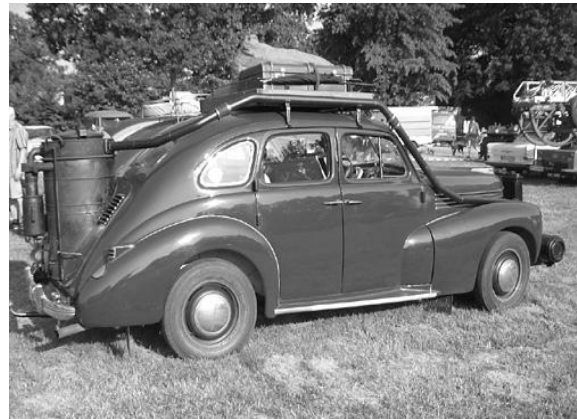
Rys. 12. Gazogenerator samochodu Opel Kapitan
