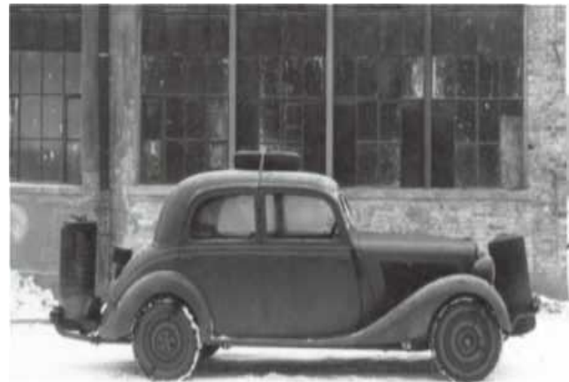
Rys. 16. Mercedes 170 VG na gaz drzewny
