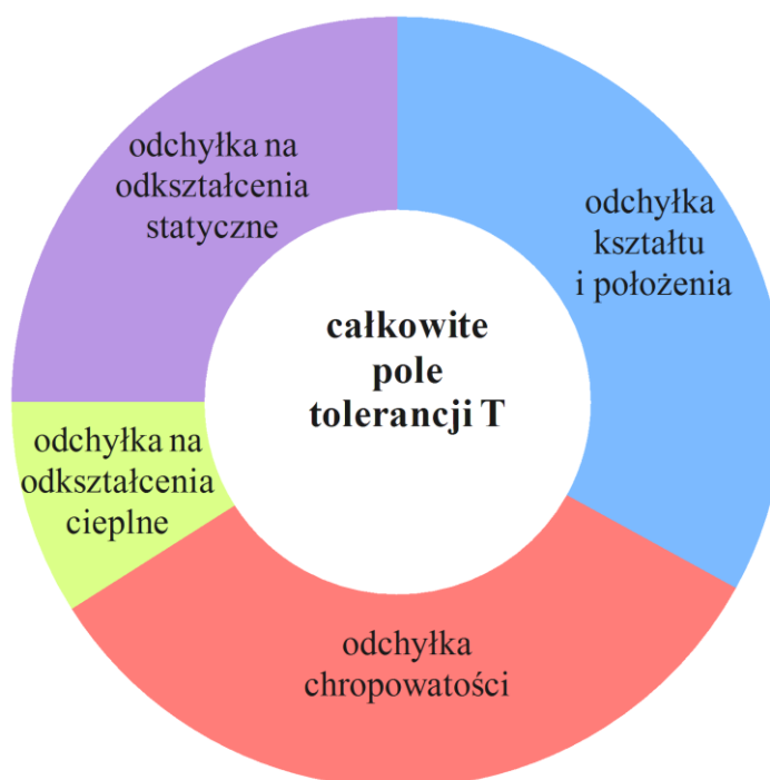
Rys. 1. Udział różnych odchyłek w polu tolerancji wymiaru [7] Fig. 1. Role of various deviations within a dimension tolerance field [7]
