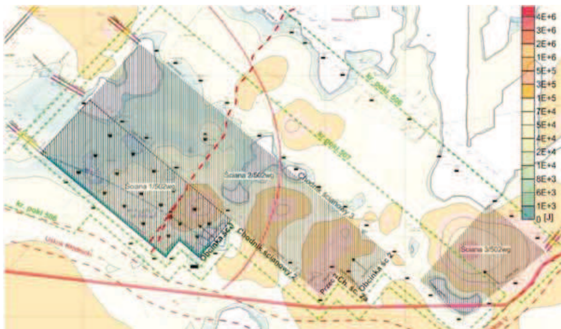
Rys. 6. Rozkład energetyczny wstrząsów zarejestrowanych w trakcie eksploatacji pokładu 507 na mapie pokładu 502wg
