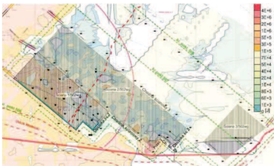
Rys. 8. Rozkład energetyczny wstrząsów zarejestrowanych w trakcie eksploatacji ściany 2 w pokładzie 502wg Fig. 8. Energy distribution of mining tremors occurring during the exploitation of longwall No.2 in seam 507 on map of seam 502wg
