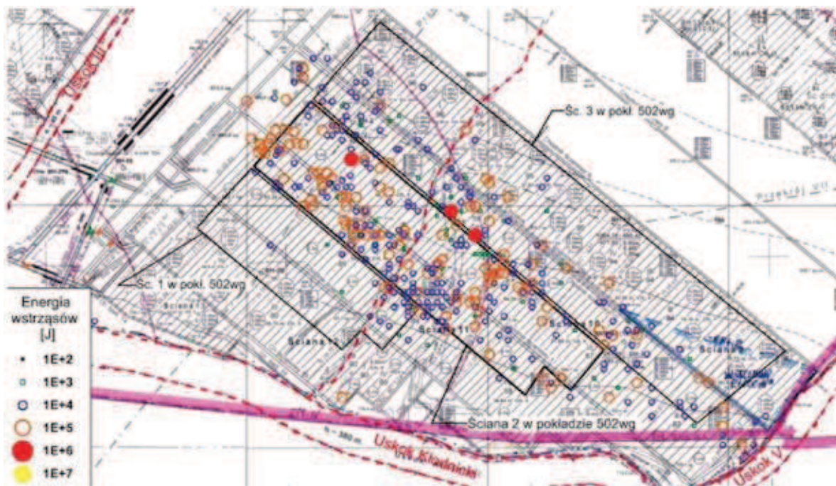
Rys. 3. Lokalizacja ognisk wstrząsów zarejestrowanych w trakcie eksploatacji ścian 10 i 11 w pokładzie 506 wraz z obrysem ścian 1÷3 w pokładzie 502wg
