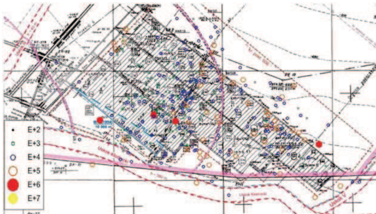
Rys. 5. Lokalizacja ognisk wstrząsów zarejestrowanych w trakcie eksploatacji pokładu 507
