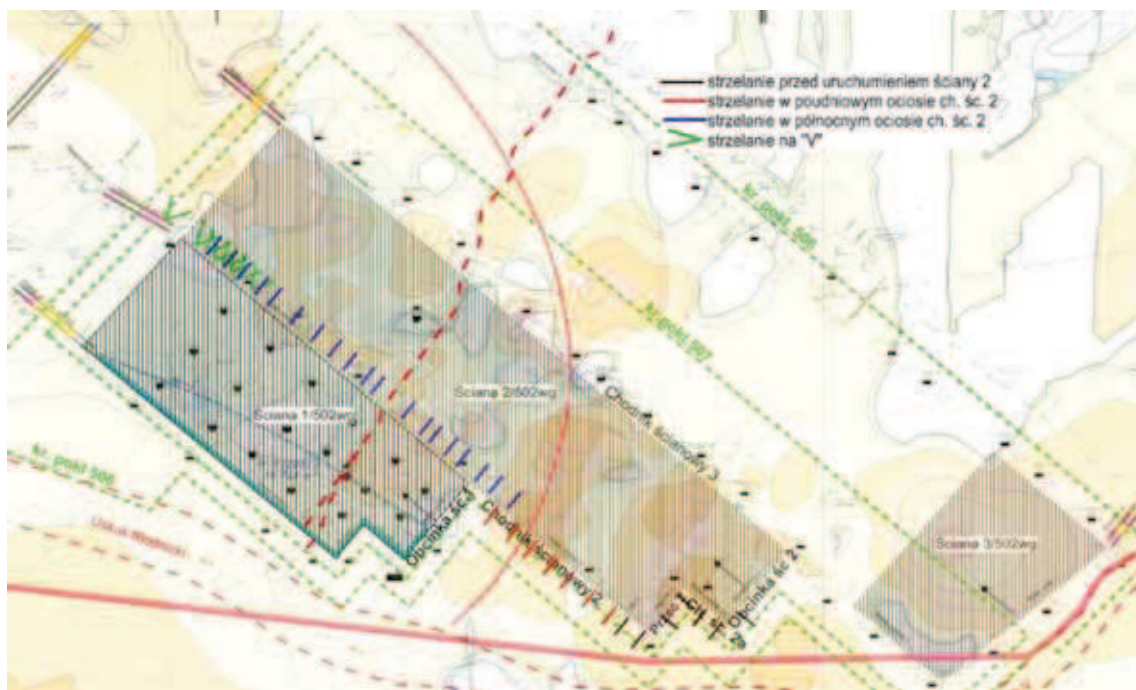
Rys. 10. Lokalizacja otworów strzałowych dla wykonania aktywnej profilaktyki w rejonie ściany 2 w pokładzie 502wg
